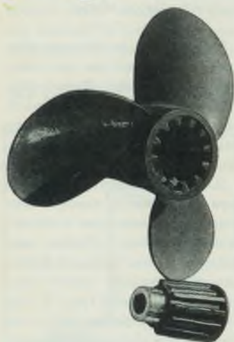
Рис. 5. Шлицевое соединение демпфера гребного винта.
